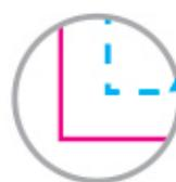
Los recuadros marcados con línea entrecortada azul delimitan la tipografía y cualquier figura que no requiera corte con la bajada de la guillotina.
